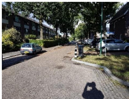
Afbeelding 2-8 Snelheidsremmende maatregelen westelijk deel Lange Dreef
